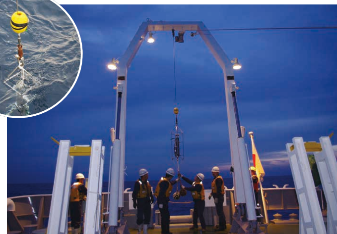
船尾甲板から水温・塩分測定器を海中に投入している様子
