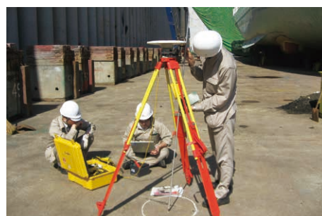
GNSSアンテナ 船底音響トランスデューサ間 位置測定の様子
